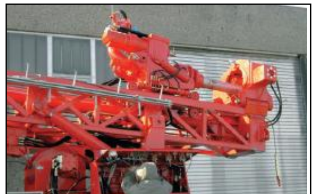
Kraftdrehkopf und Abfangvorrichtung / Power swivel and clamping device
